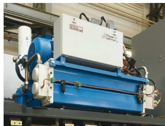
Der Adsorptionstrockner in der für Stadler realisierten Lösung wird liegend eingebaut
