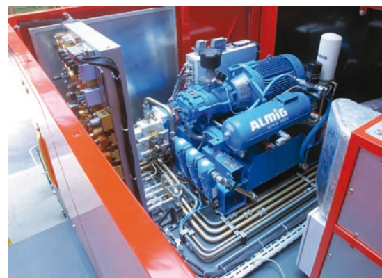
Die Track-Air-Schraubenkompressoren werden als Komplett-Paket mit Antrieb, Trockner, Steuerungen, Kondensatbehälter usw. geliefert
